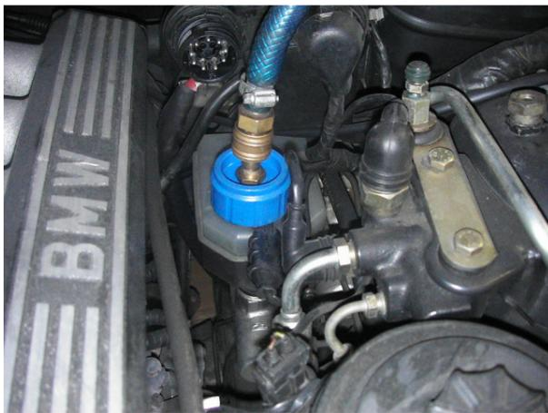
Mit einem Druckluftschlauch konstant 2 Bar Druck auf die gesamte Anlage gegeben.
