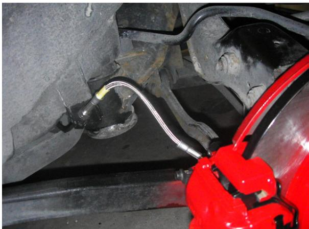
Anschließen der Bremsleitung, fertig.
