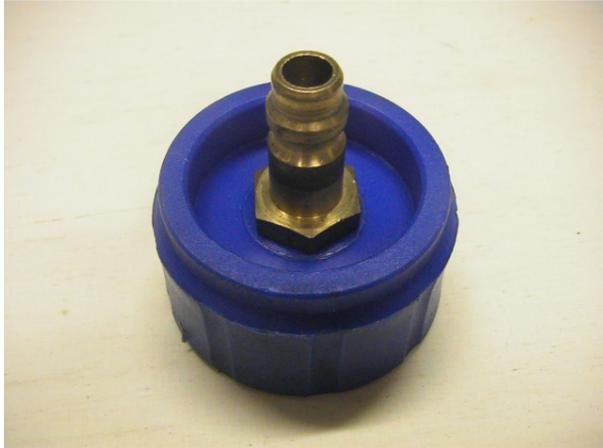
Ein Deckel, passend für den Bremsflüssigkeitsbehälter, genommen, ein Anschlussstück für einen Druckluftschlauch passgenau in den Deckel eingearbeitet.
