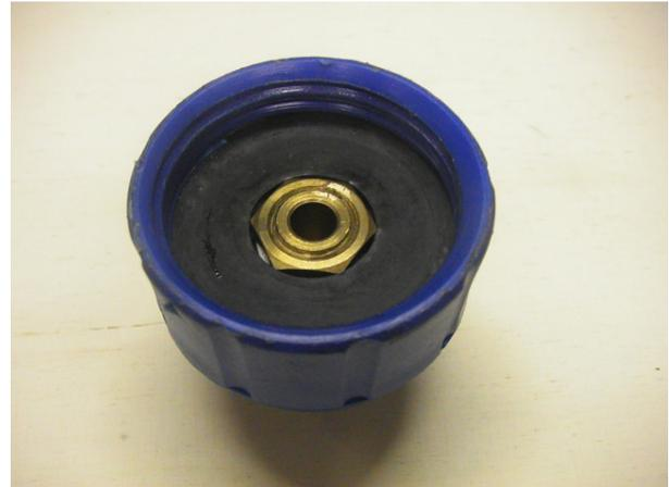
Am Original-Deckel den elektrischen Anschluß für den Stand der Bremsflüssigkeit entfernt, und den Deckel gegen den „Druckluftdeckel“ getauscht (vorher noch genügend Bremsflüssigkeit einfüllen).
